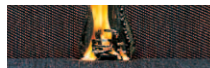
Per il settore interni vengono prescritti test con diverse fonti d'accensione, come questa catasta di legna ardente sull'imbottitura del mobile (BS 5852 II, crib 5).
